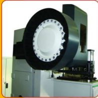
تعویض کننده ابزار ۲۴ عددی (سفارش‌شی) (Disc Type)
